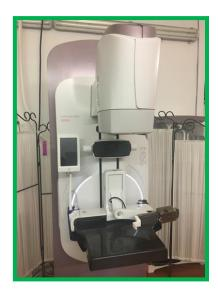
**Abbildung Nr. 3 – Verwenden Sie keine Gantry Rotation für das Biopsieverfahren:** Senographe Pristina Gantry in 90 ° Position rotiert.
