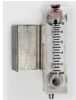
Flussometro esterno di backup, numero di parte 147361. Utilizzare un flussometro esterno per confermare la portata
