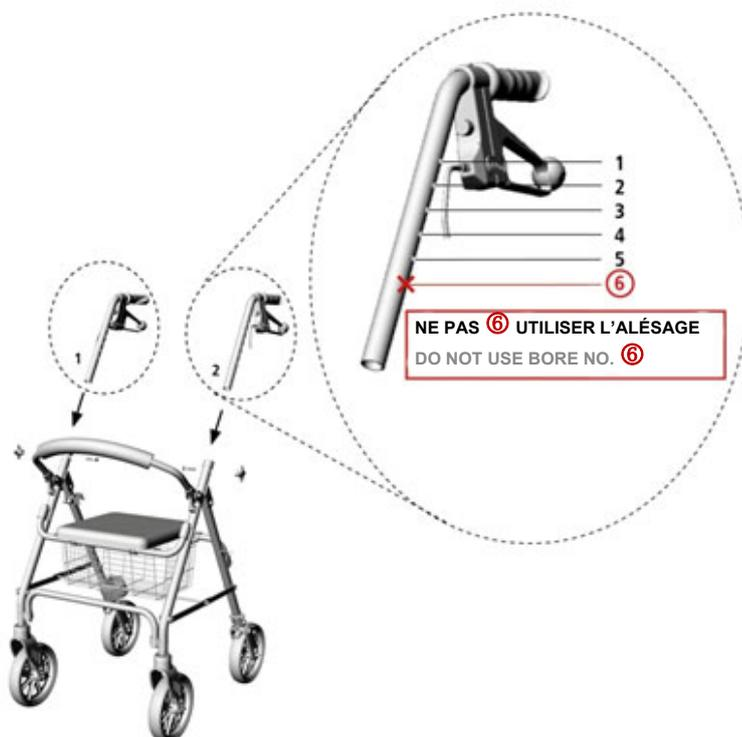
Cette restriction minimise la tendance du déambulateur à basculer vers l'arrière, ainsi que le risque de rupture du cadre supérieur.
