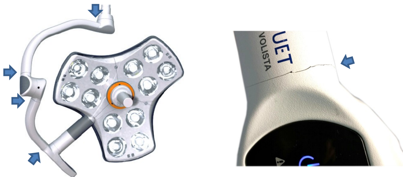
Fig. 1 : phénomène de fissuration du revêtement
