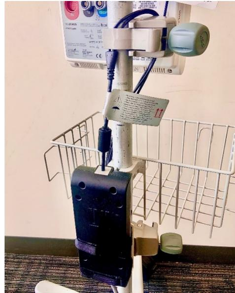
Netzteil-Block mit Abdeckung
