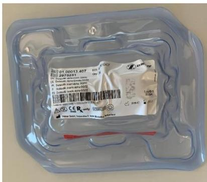
Abbildung 1: Verformte Blisterverpackung
