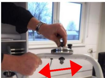
Vous ne devez pas détecter de mouvement entre les éléments de la suspension et du fléau (point d'essai 1-3).
