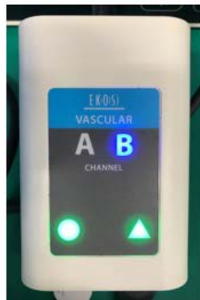
Abbildung 1 (a) Richtige Orientierung der Indikatorfolie bei Betrieb von Kanal B
