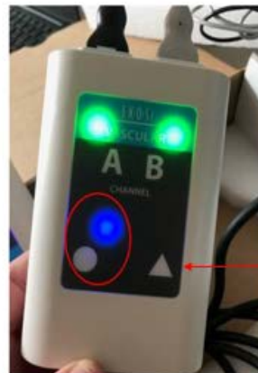
(b) Falsche Orientierung der Indikatorfolie bei Betrieb von Kanal B
