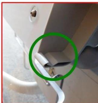
Abbildung 1C - Gebrochene Verriegelung
