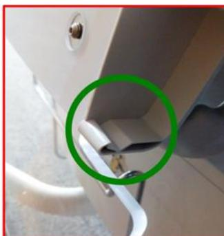
Abbildung 1D – Verriegelung in gutem Zustand
