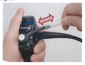
Attaccare e staccare il tubo di ingresso solo con la forza di spinta/trazione nella direzione della valvola di aspirazione.
