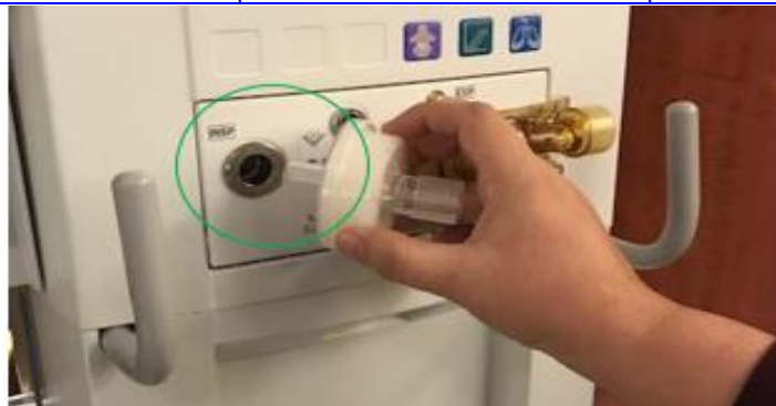
Figura 3: Porta di Uscita del Respiratore con la connessione della protezione inspiratoria.
