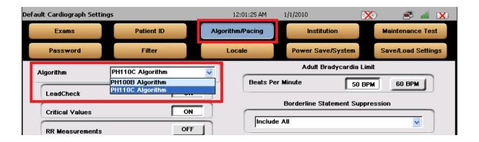
**REMARQUE**: PH100B et PH110C sont les derniers algorithmes DXL, dotés de multiples corrections de bogues et améliorations. Philips recommande au client d'utiliser le dernier algorithme PH110C.
