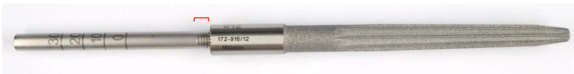
Abbildung 2: Führungsstab kann nicht vollständig in den Schaft eingeschraubt werden / Figure 2: Guide rod can't be screwed into stem completely
