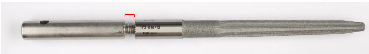
Abbildung 1: Fräsführung kann nicht vollständig in den Schaft eingeschraubt werden / Figure 1: Reaming guide can't be screwed into stem completely
