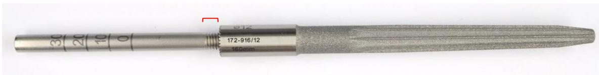
Abbildung 2: Führungsstab kann nicht vollständig in den Schaft eingeschraubt werden /
