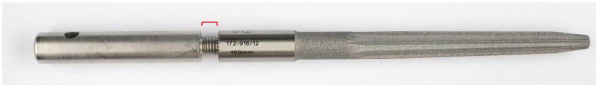
Abbildung 1: Fräsführung kann nicht vollständig in den Schaft eingeschraubt werden /
