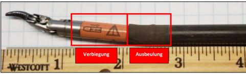
**Abbildung 1.** Beispiel eines Instrumentenschadens in Verbindung mit dieser Rückrufmaßnahme von betroffenen MCS-Instrumenten
