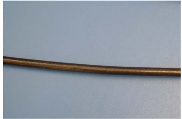
Figura 6: Cavo Motore intatto e non danneggiato
