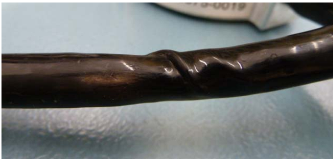
Figura 7: Cavo Motore danneggiato
