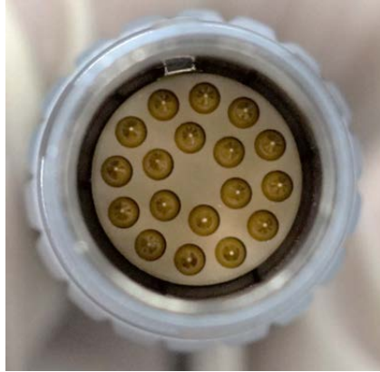
Figure 2 : Vue des pinoches du Connecteur du Moteur
