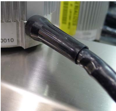
Figure 5 : Câble endommagé au niveau du réducteur de torsion Moteur
