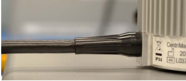
Figure 4 : Gaine réductrice de torsion du câble au niveau du Connecteur du Moteur
