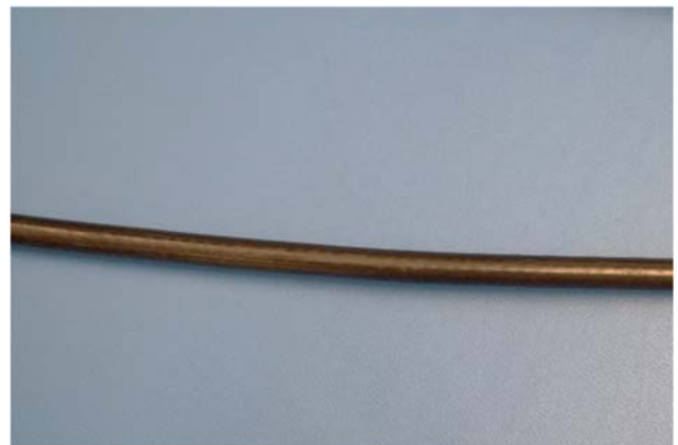
Abbildung 6: Unbeschädigtes, intaktes Motorkabel
