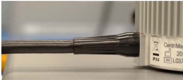
Abbildung 4: Kabel-Knickschutz am Motor
