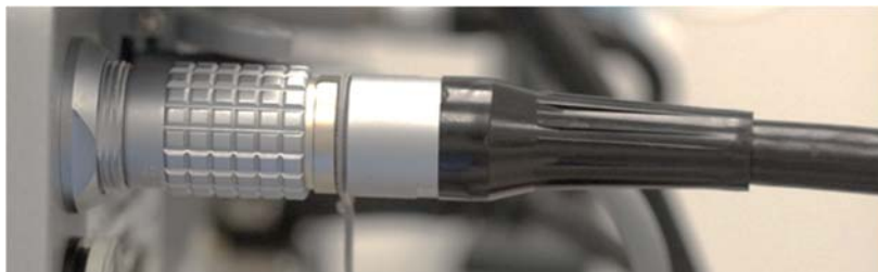
Abbildung 3: Kabel-Knickschutz am Konsolen-Steckverbinder
