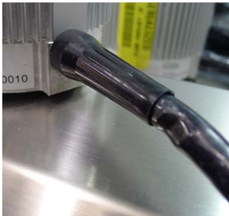
Abbildung 5: Kabelschaden am Motor-Knickschutz
