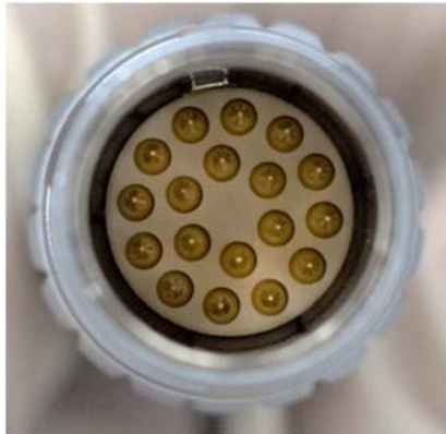
Abbildung 2: Ansicht der Stifte des Motor-Steckverbinders
