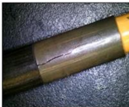
Figure 2. Exemple de fissure retrouvée sur les instruments MCS endommagés
