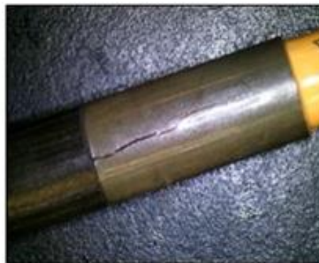
Abbildung 2. Beispiel eines Risses bei einem beschädigten MCS-Instrument
