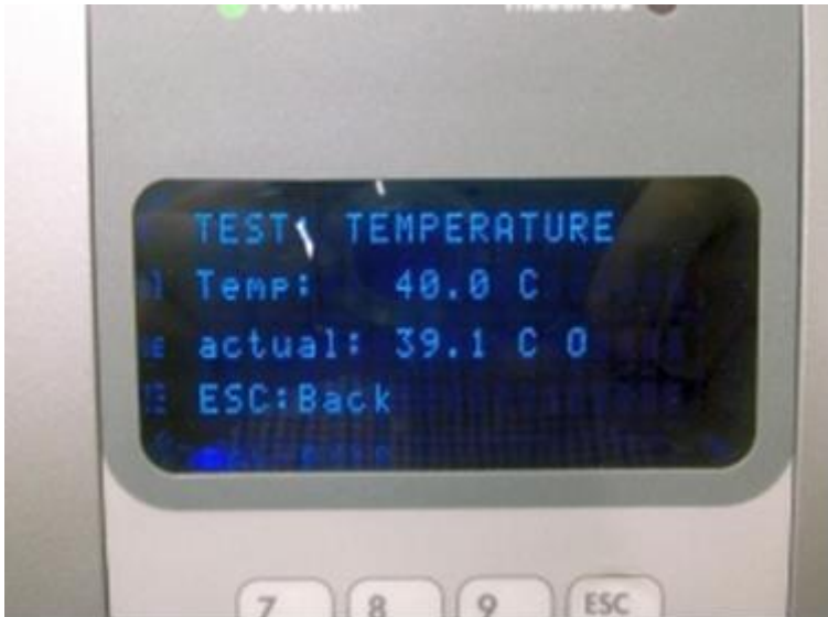
Abbildung 1: Anzeige des EZ1 Advanced XL Geräts bei einem erfolgreichen Temperaturtest. Hinweis: Achten Sie besonders auf das „O“ hinter der Isttemperatur („actual“).
