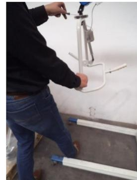
6. Essayez de glisser la jauge d'épaisseur (épaisseur 0,2 mm) entre le disque supérieur et le crochet de sécurité.
