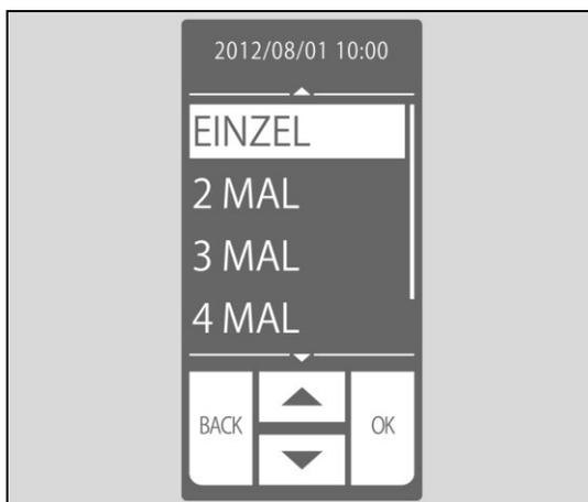
5. Die aktuelle Einstellung für Messbereichsmeldung festlegen. KONFIG. > EINHEIT auswählen. Es wird einer der unten dargestellten Bildschirme angezeigt. Die Standardeinstellung für Geräte mit SW 1.20 oder höher ist HI: >20 oder HI: >340, abhängig von der konfigurierten Einheit. Bei Geräten mit SW 1.10 oder niedriger kann die Standardeinstellung nicht bearbeitet werden und wird nur als blinkende Null angezeigt.
