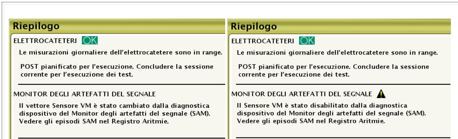
Un episodio del SAM include un EGM, il vettore del sensore associato e i valori di impedenza dell'elettrodo. Le impedenze del sensore RA/RV anello>>cassa e punta>>cassa sono nuovi dati diagnostici che insieme alle impedenze dell'elettrodo di stimolazione possono contribuire a stabilire se l'integrità dell'elettrocattetero o la sua connessione sono compromesse (vedere la Tabella 3).
