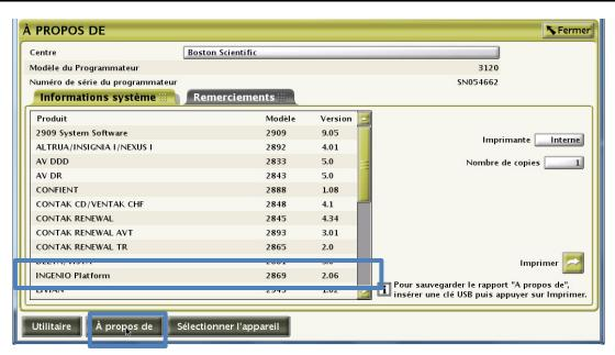
Sélectionnez le bouton « À propos de » (About) et vérifiez le modèle et la version du logiciel.
