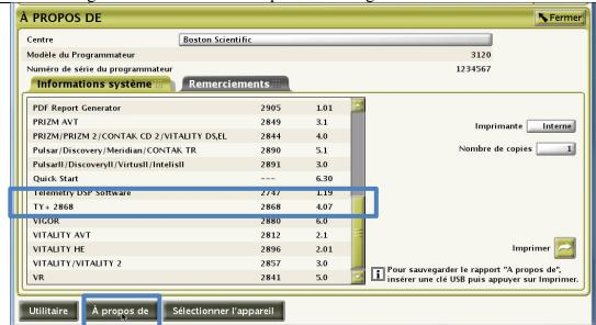
Le logiciel v4.07 modèle 2868 précédemment déployé prend en charge les CRT-D du tableau 2.
