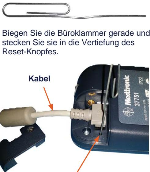
Biegen Sie die Büroklammer gerade und stecken Sie sie in die Vertiefung des Reset-Knopfes.
