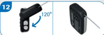
Ruotare l'adattatore in senso orario fino a quando si ferma. L'adattatore è posizionato correttamente quando è allineato al microinfusore. Premere quindi
