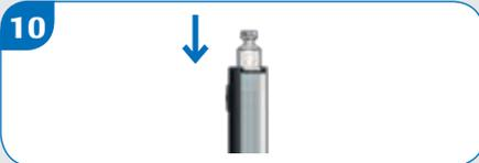
Assicurarsi di tenere il microinfusore in posizione verticale. Inserire la cartuccia – per primo il lato con lo stantuffo – nel vano portacartuccia.
