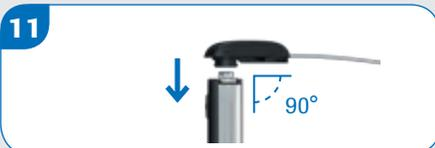
Posizionare un adattatore nuovo sulla presa a baionetta del vano portacartuccia. Assicurarsi di inserire ad angolo retto (90°) la testina dell'adattatore nell'incavo del microinfusore. In caso contrario si potrebbe piegare l'ago.
