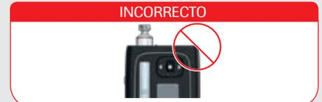
**Non** spingere la cartuccia nel microinfusore se la cartuccia spunta fuori. Si potrebbero danneggiare il microinfusore o la cartuccia. Assicurarsi che l'asta del pistone sia completamente arretrata. Se l'asta del pistone non è arretrata completamente, **contattare il Servizio Assistenza.**
